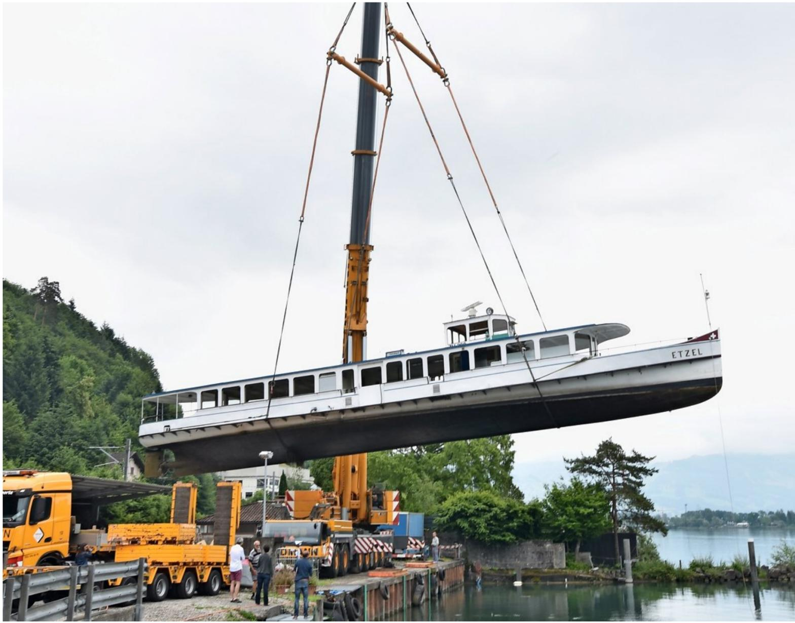
Das 58 Tonnen schwere Schiff baumelt am Kranhaken.
