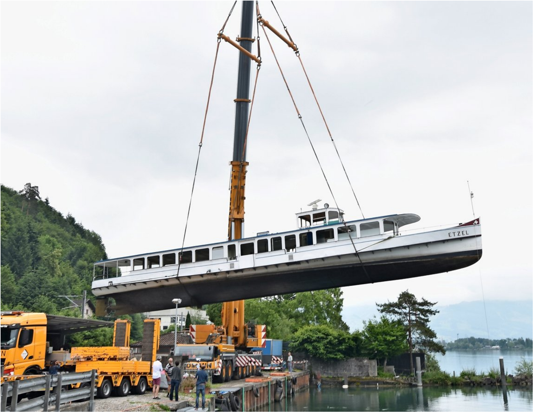
Das 58 Tonnen schwere Schiff baumelt am Kranhaken.
